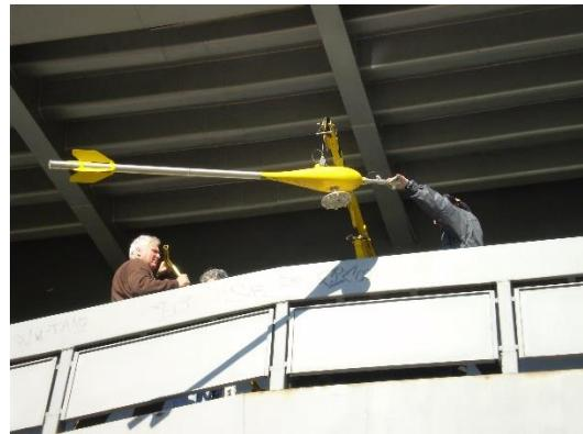
Zariadenie sa spúšťa do vody na oceľovom lane, v pravidelných rozstupoch, tzv. zvisliciach (v tomto profile spravidla po 10 metroch). V každej zvislici sa rýchlosť prúdenia vody meria v 5 bodoch – tesne nad dnom, v 0,2-násobku, 0,4-násobku , 0,8-násobku hĺbky vody v danej zvislici a tesne pod hladinou.
