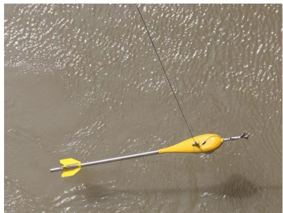
Ukážeme Vám aj ultrazvukový prístroj na meranie prietokov (ADP). Môžete sa presvedčiť, že meranie pomocou tohto prístroja je v porovnaní s meraním hydrometrickou vrtuľou oveľa rýchlejšie a menej prácne.
